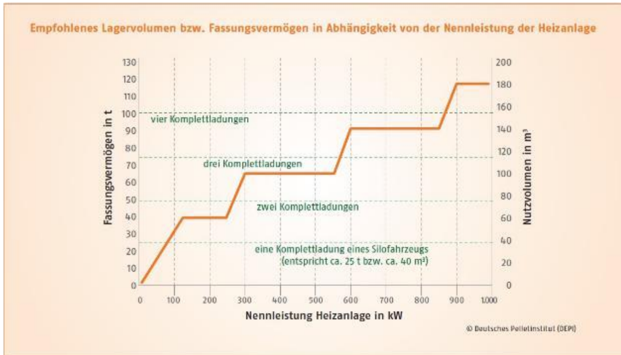
Abbildung 16: Empfohlenes Nutzvolumen für Grosslager in Abhängigkeit von der Kesselleistung.
