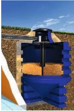
Abbildung 6: Erdlager aus Kunststoff mit Saugentnahme von unten
